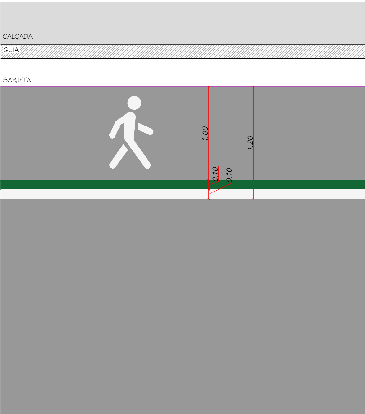
DETALHE QUEBRA-MOLAS (TACHÕES) ESCALA 1:25
